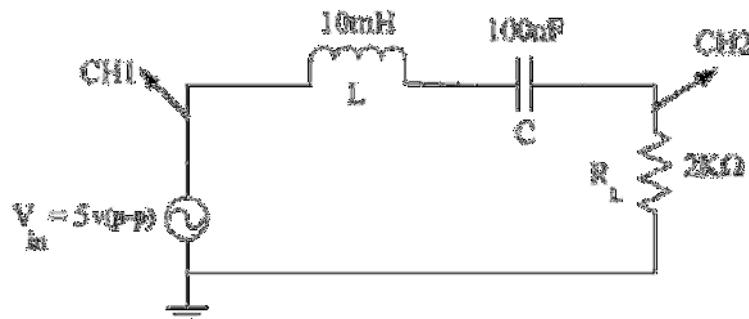
نکته مهم: پس از هر بار تغییر فرکانس سیگنال ژنراتور، دقیق کنید که دامنه  $V_{R(p-p)}$  همواره ثابت و 5V بماند.
